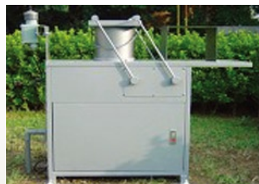
臺北氣象站酸雨採樣器
