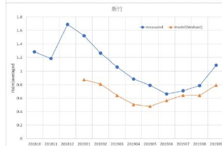
圖 4、模式及觀測月平均波高比較圖(上圖為馬祖測站、下圖為新竹測站)，模式不包含預報值
