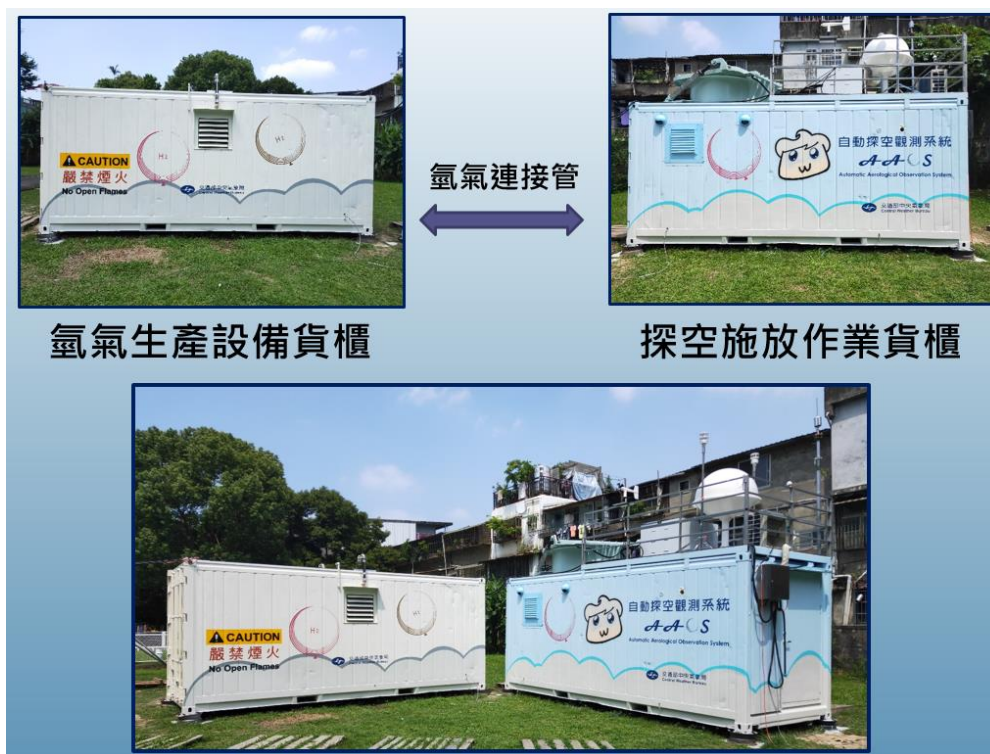
圖 3.3.1 含產氫設備及探空作業設備的自動探空觀測系統。 Figure 3.3.1 AAOS contains operating cabin and hydrogen cabin
