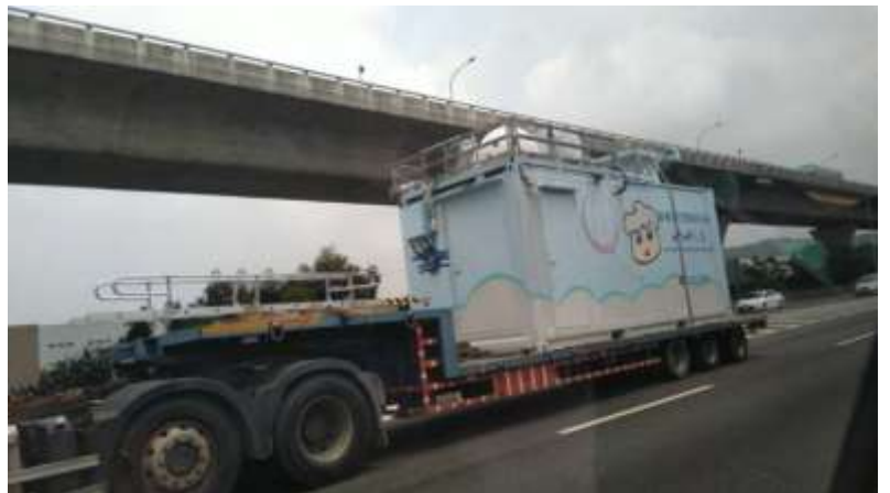
圖 3.3.3 AAOS 貨櫃吊掛及運送。 Figure3.3.3 Hoisting and transportation of the AAOS cabins
