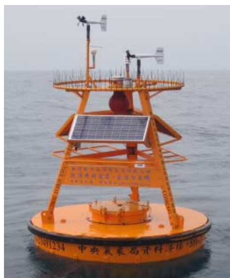
圖 3.1.6 資料浮標觀測平台
